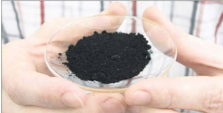
Unscheinbar aber kraftvoll: Dieses schwarze Pulver sind die Nanotubes, die dafür sorgen, dass Beton filigraner verbaut werden kann und trotzdem noch stabiler ist. WP-Fotos: Tim Meyer
